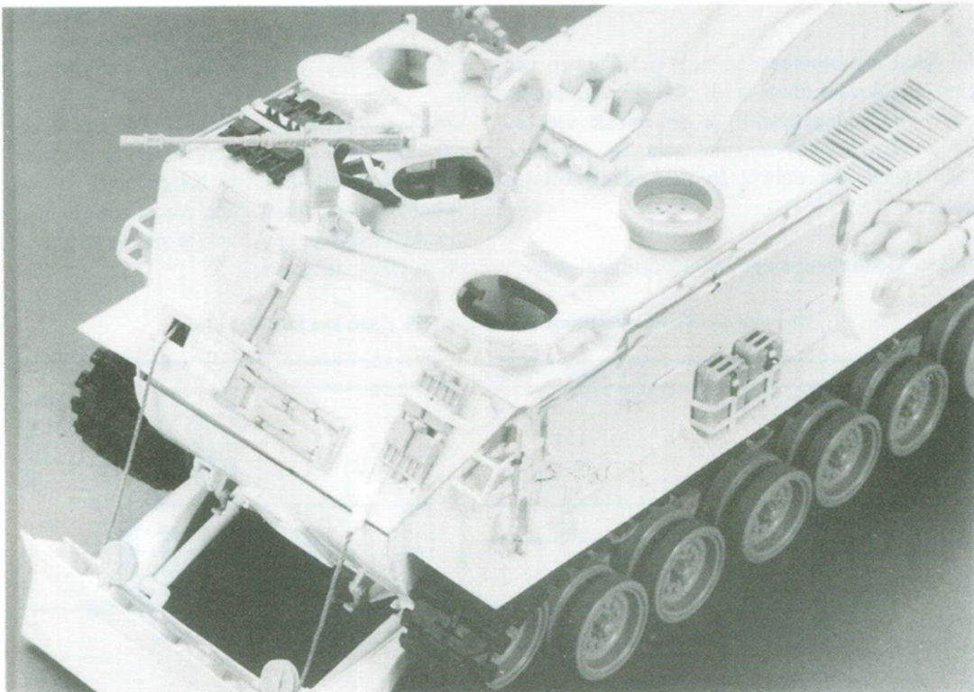
De cabine. Let op de indeling en de plaats van de hulplier.
